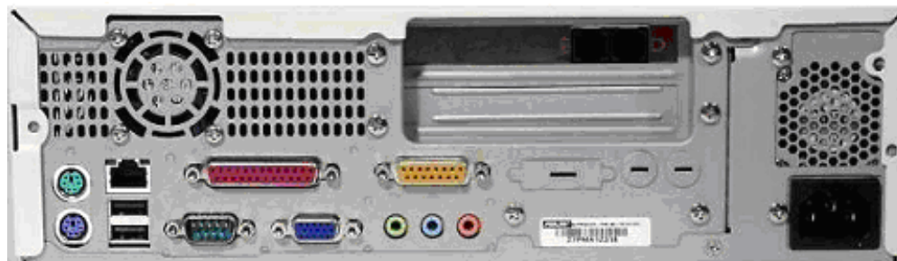
Hình 1.9: Bố trí các cổng giao tiếp phía sau vỏ máy tính
