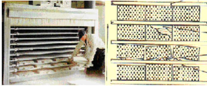
Hình 4.4. Tủ đông tiếp xúc và các yếu tố ảnh hưởng đến mức độ tiếp xúc, truyền nhiệt trong tủ đông tiếp xúc
