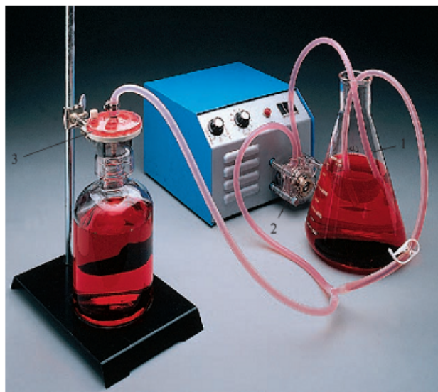
Thiết bị màng lọc: 1-Bình Erlenmeyer đựng dịch cần lọc. 2-Dịch lọc được đẩy sang thiết bị màng lọc nhờ máy bơm. 3-Thiết bị màng lọc (với các loại hình các kích cỡ khác nhau).
