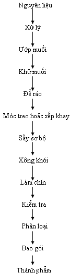
Hình 6.7 Sơ đồ qui trình chế biến sản phẩm cá xông khói
