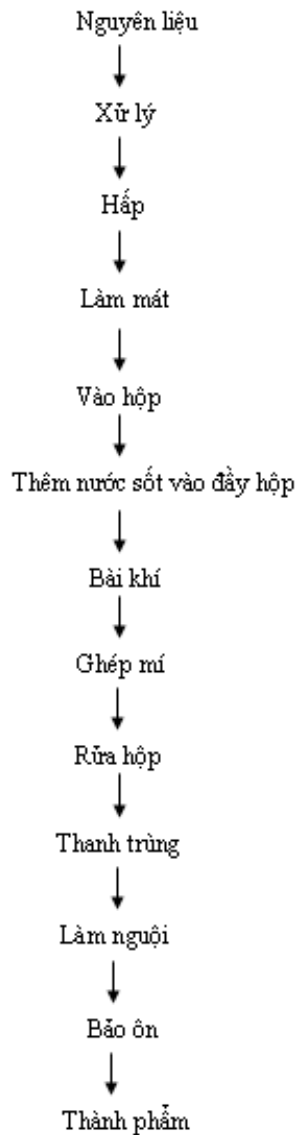
Hình 6.9 Sơ đồ qui trình chế biến sản phẩm cá sốt cà
