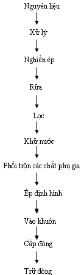
Hình 6.10 Sơ đồ quy trình chế biến sản phẩm surimi
