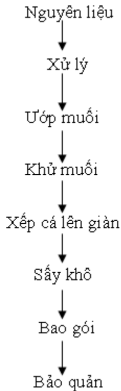
Hình 6.6 Sơ đồ quy trình chế biến sản phẩm cá sấy
